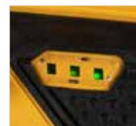
Luces LED del estado de carga de la batería
