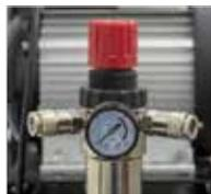
Válvula de salida con regulación de presión
