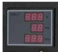
Pantalla (tensión, frecuencia y horómetro)
