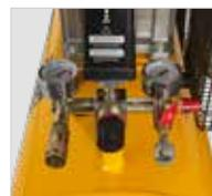
Conector con acoplamiento rápido + grifo macho/hembra
