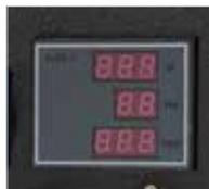
Pantalla (tensión, frecuencia y horómetro)
