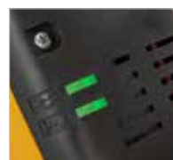
LED estado das escovas e alimentação elétrica
