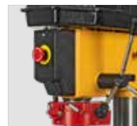
Interruptor de paragem de emergência
