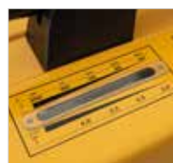
Ciclo de trabalho / diâmetro do eletrodo
