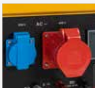
Monofásica - 230 V AC 50 Hz - Trifásica - 480 V AC 50 Hz
