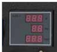
Display (tensão, frequência e contador de horas)
