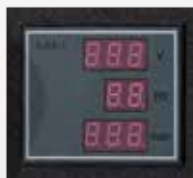
Display (tensão, frequência e contador de horas)
